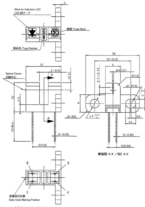
(注 1)(Note1) 指示無き寸法公差は±0.3。/Not appointment tolerance :±0.3. (注 2)(Note2) ※リード根元寸法とする。/※Indicates root dimensions of lead.
