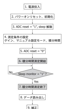
積分時間を測定し、補正係数を求めることで感度ばらつきを軽減できます。
