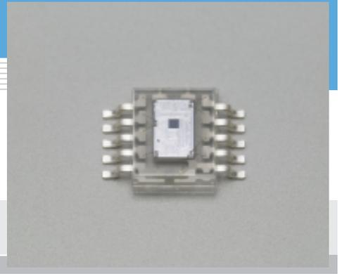
光電スイッチとして必要な機能を内蔵したフォトICです。LEDと共に使用し、透過型、反射型の光電スイッチを容易に構成できます。
