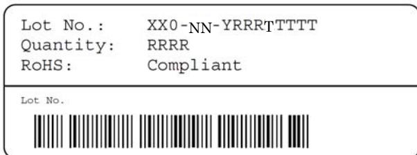
図 19：リール上の最初のラベル：XX = センサタイプ (11 ならば SHT11)、(V4)、NN=チップのバージョン番号 (04 ならば Ver.4)、Y = 製造年の最終桁、RRR=リール内のセンサ数を 10 で割った数 (200 ならば 2000 個巻きリール)、TTTT = トレーサビリティコード。
